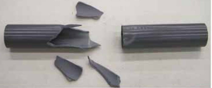
VP50 ネジ継手破損状況
