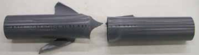
VP50 差し込み継手破損状況
