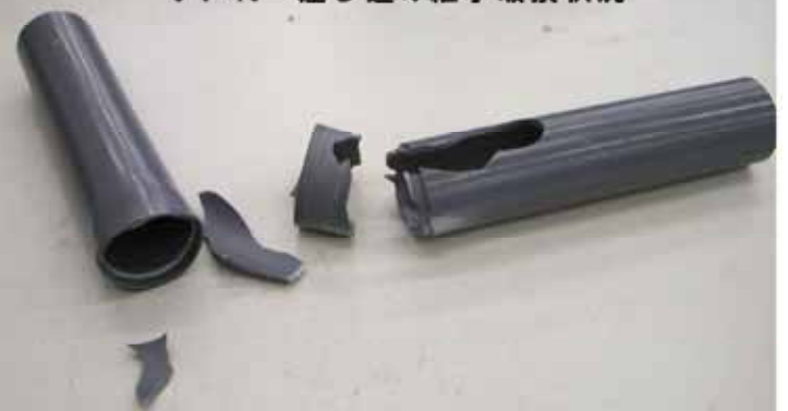
VP40 差し込み継手破損状況
